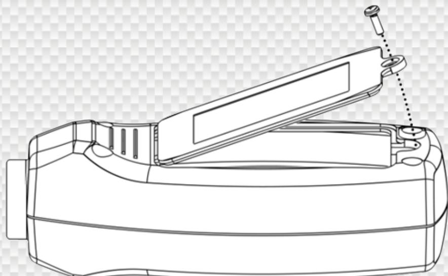
Die Stromversorgung des Messgeräts erfolgt mit Alkali-Batterien vom Typ 1,5 V LR6 (AA) - 2 Stk. Die auf dem Display des mobilen (externen) Geräts angezeigte Anzeige des Ladezustands der Batterie zeigt an, dass die Batterien gegen neue ausgetauscht werden müssen. Der Stand ihrer Entladung wird in Prozenten in der linken unteren Ecke des Hauptmenüs der App NexPTG angezeigt.
