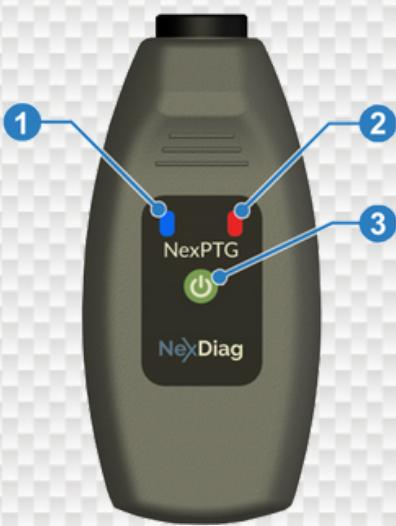
Um das Messgerät NexPTG in Betrieb zu nehmen, ist 3 Sekunden lang Button 3 zu halten, bis auf dem Panel die Versorgungsdiode 2 leuchtet. Dann nehmen wir die App NexPTG auf dem mobilen (externen) Gerät in Betrieb. Die ordnungsgemäße Kommunikation wird signalisiert, indem die blaue Diode 1 angeht.
